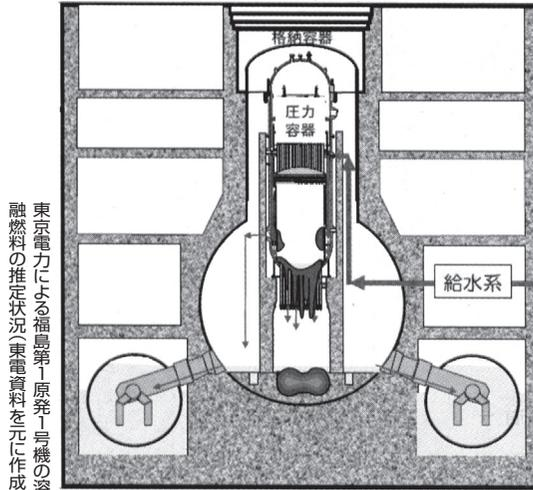
東京電力による福島第一原発1号機の溶融燃料の推定状況(東電資料を元に作成)
